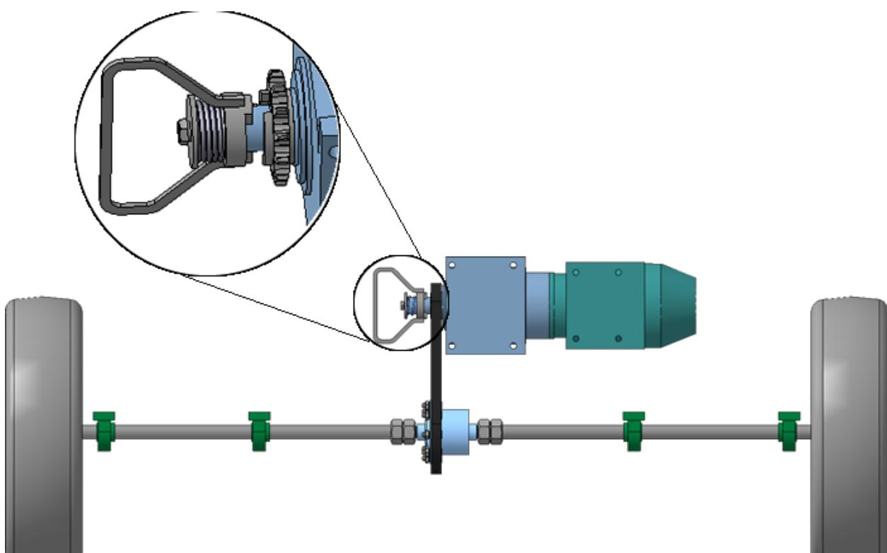
Рис. 4 – Механизм хода
